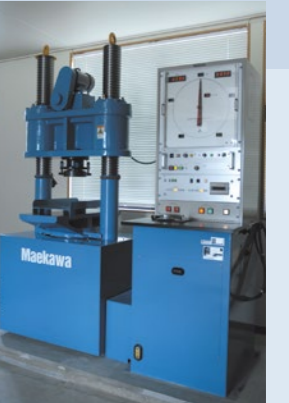
耐圧試験機 前川試験機製ACA-200A アムスラー型2000KN
